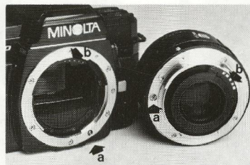
Fokusbevægelsen overføres fra kamerahuset til objektiverne via koblingen »a«. Kontakterne »b« overfører oplysninger om brændvidde, lysstyrke og blænde.
